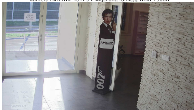
Kamera AVILINK-4S125 z włączoną funkcją WDR 130dB
